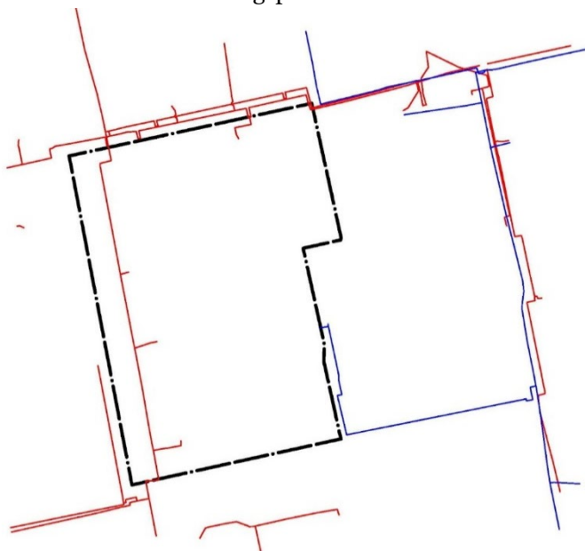
Bild. Befintliga fjärrvärmeledningar i rött och fjärrkyleledningar i blått i relation till planområdesgränsen i svart.
