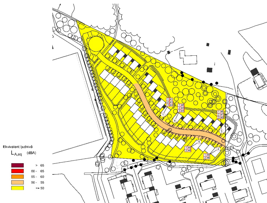
Illustration av ekvivalenta ljudnivåer inom planområdet ur bullerutredningen (Soundcon, 2022-06-06). Riktvärden för ekvivalenta ljudnivåer på 55 dBA vid fasad överstigs inte.
