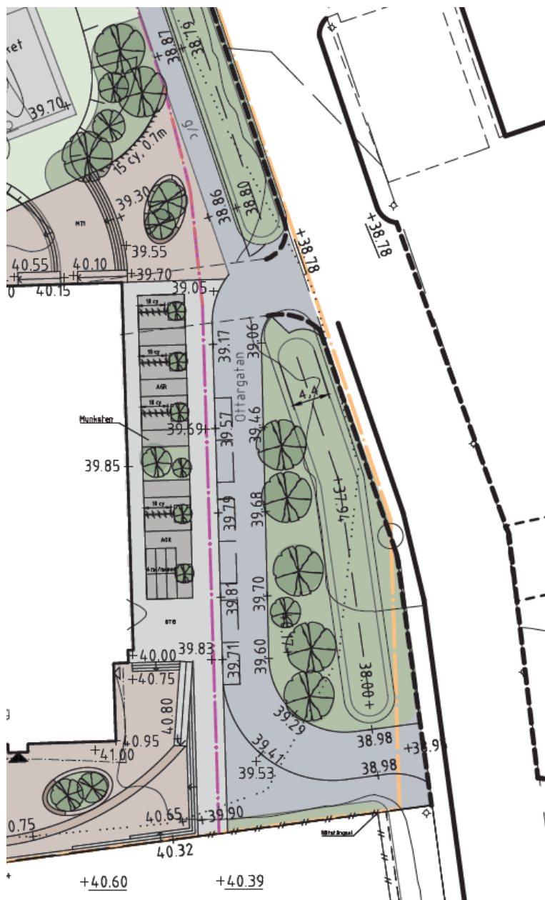
Bild 41. Utformning angöringsyta i öster, lila prick-streckad linje visar gräns mellan allmän plats och kvartersmark. (Tengbom)
