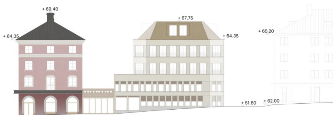
Fasadritning mot Nygatan i norr. Ritningens höjder anges i meter över nollplanet, Jägnefält Milton.
