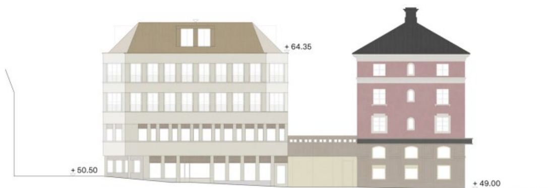
Fasadritning mot Stora Bastugatan i söder. Ritningens höjder anges i meter över nollplanet, Jägnefält Milton.
