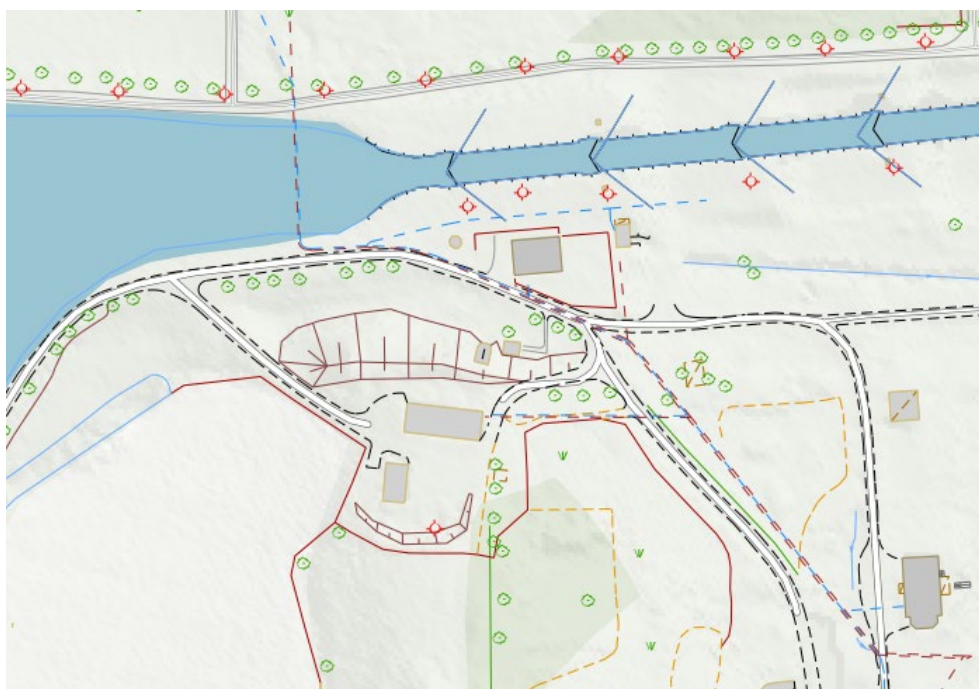
Bild. Befintliga vatten- och spillvattenledningar i området (markerade med blå och brun kulör). Privat ledningsnät söder om kanalen.
