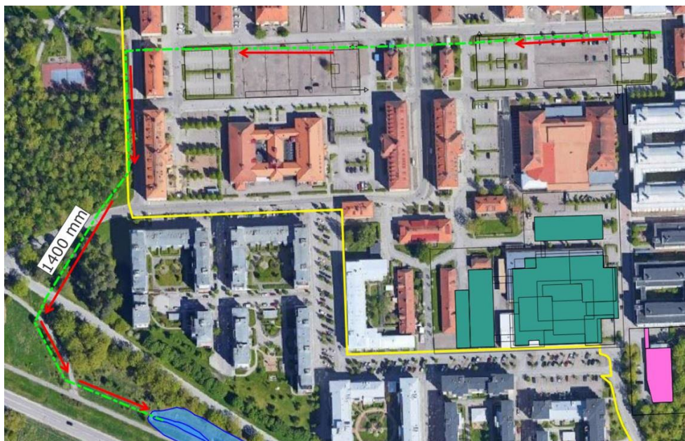
Dagvattenledning mellan planområdet och damm 1 som skulle behöva uppdimensioneras för att kunna omhänderta ett 10-årsregn från ARO 1 (Ramboll)
