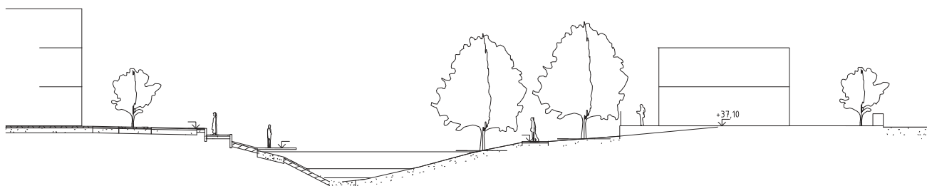
Typsektion 1 för mötet mellan fastighetsgränser och Smedstadsbäcken.
