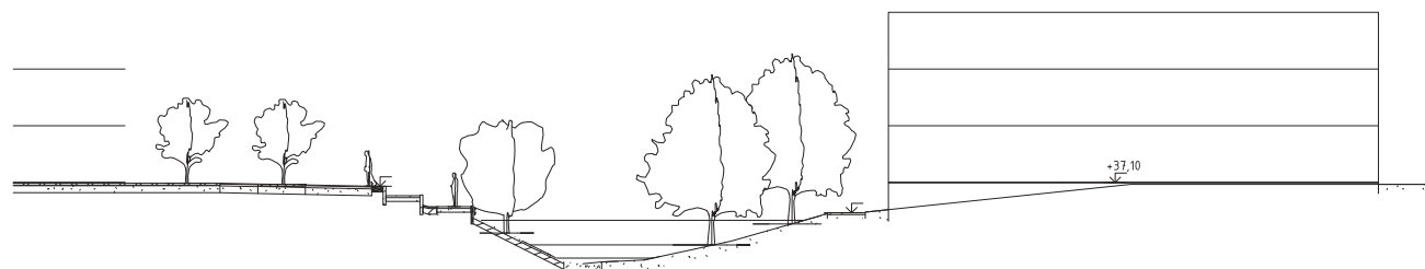
Typsektion 2 för mötet mellan fastighetsgränser och Smedstadsbäcken.
