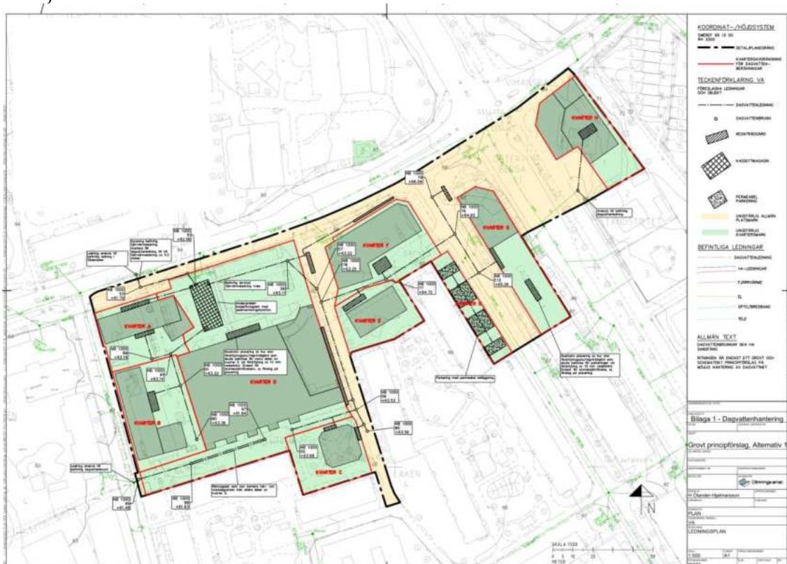
Figur 19. Översiktligt förslag på dagvatten- och skyfallshantering inom detaljplaneområdet. Allmän platsmark visas med gulmarkerade områden. Kvartersmark visas grönmärkta. För en mer detaljerad bild, se bilaga 1.
