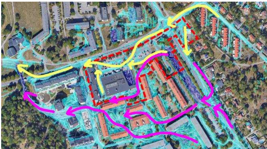
Figur 17. Maxflödet i det gula stråket uppskattas öka från ca 0.8 m 3 /s till ca 1.2 m 3 /s.
