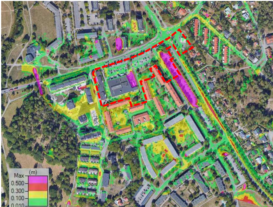
Figur 8. Beräknade maximala vattendjup i skyfallsmodellen. Generellt sett rinner skyfallsvatten av från området, men fastnar i några lågpunkter. Visar vattendjup mellan 0.01 – 0.5 meter.
